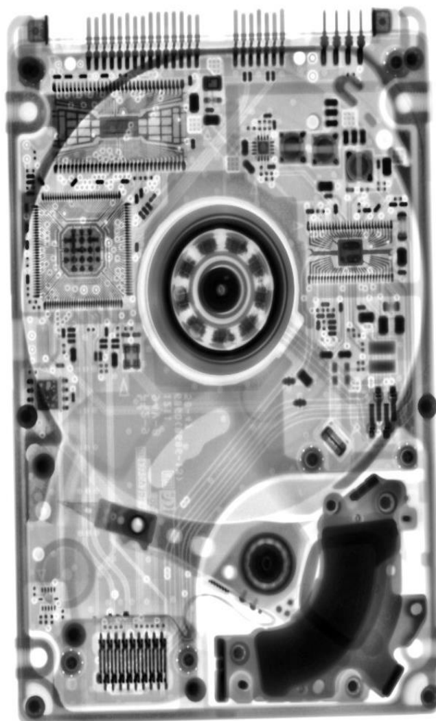
Рисунок 6 – Цифровой радиографический снимок жёсткого диска
