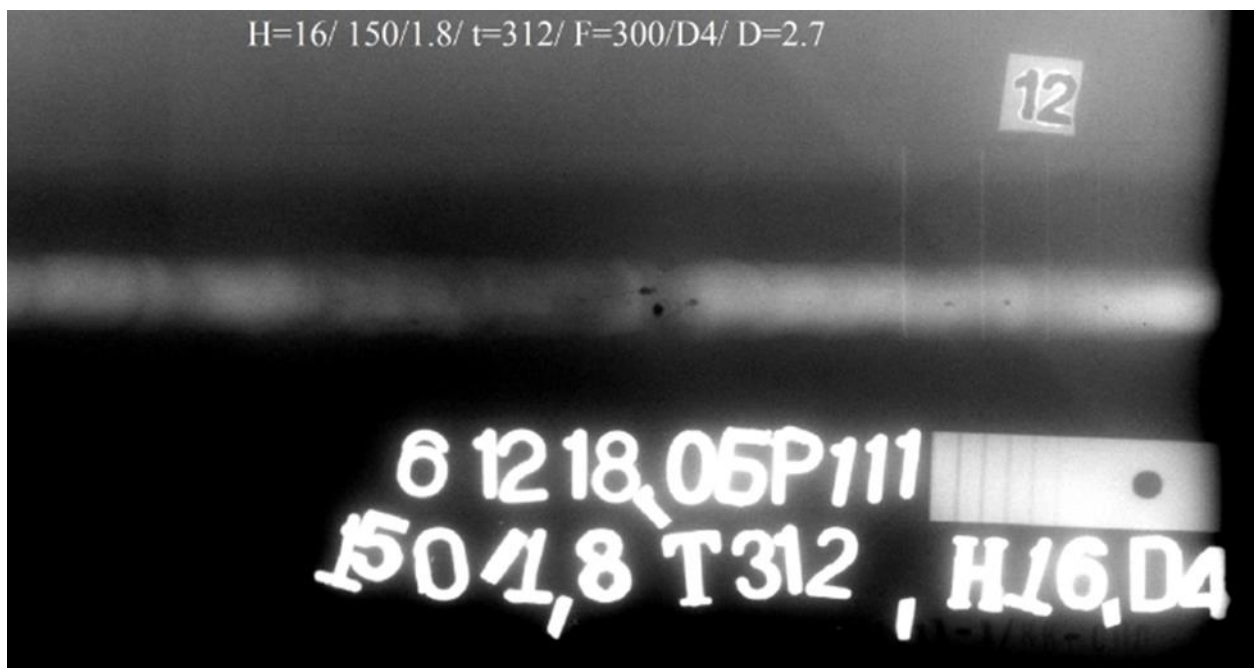
Рисунок 4 – Рентгеновское изображение стальной пластины, полученное с помощью рентгеновской плёнки
