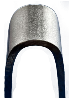
изгиб без трещины
